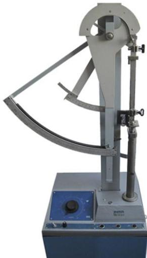
Машины разрывные для бумаги РМБ-3, РМБ-10М, РМБ-30-2М предназначены для определения разрывного усилия и удлинения при разрыве полоски бумаги.
