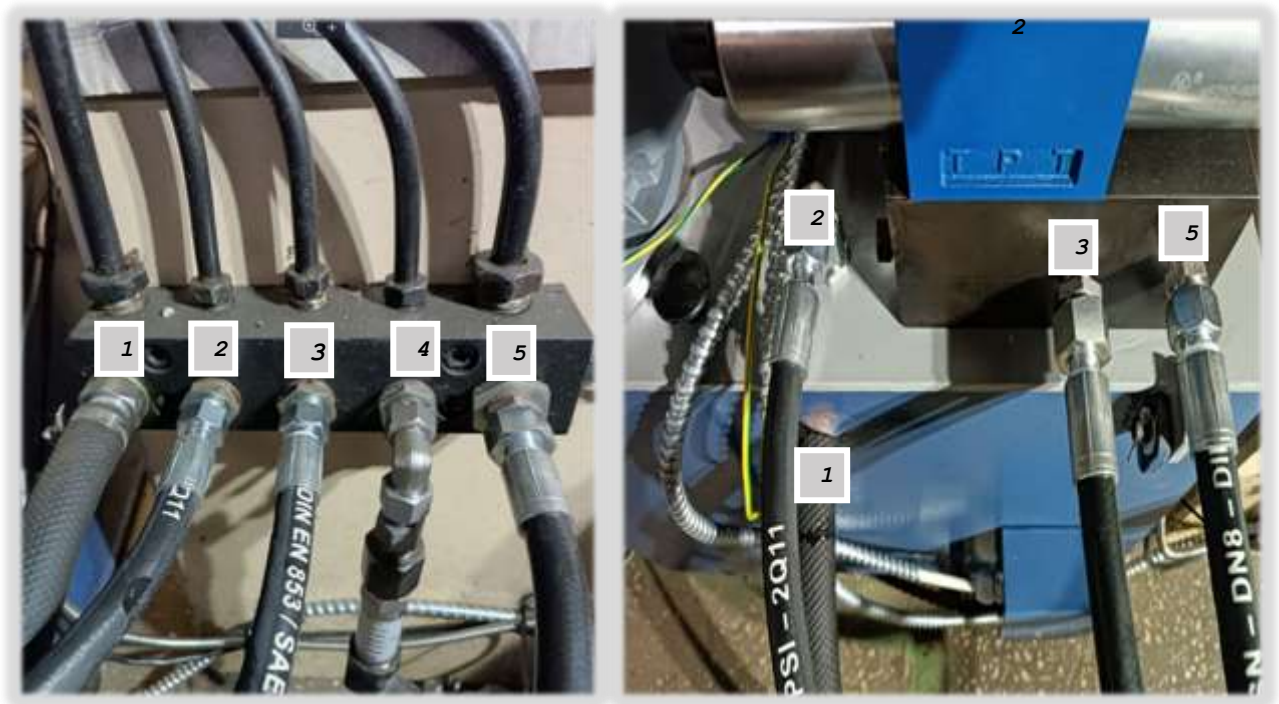
Мал. 4-5 : Підключення рукавів високого та низького тиску
