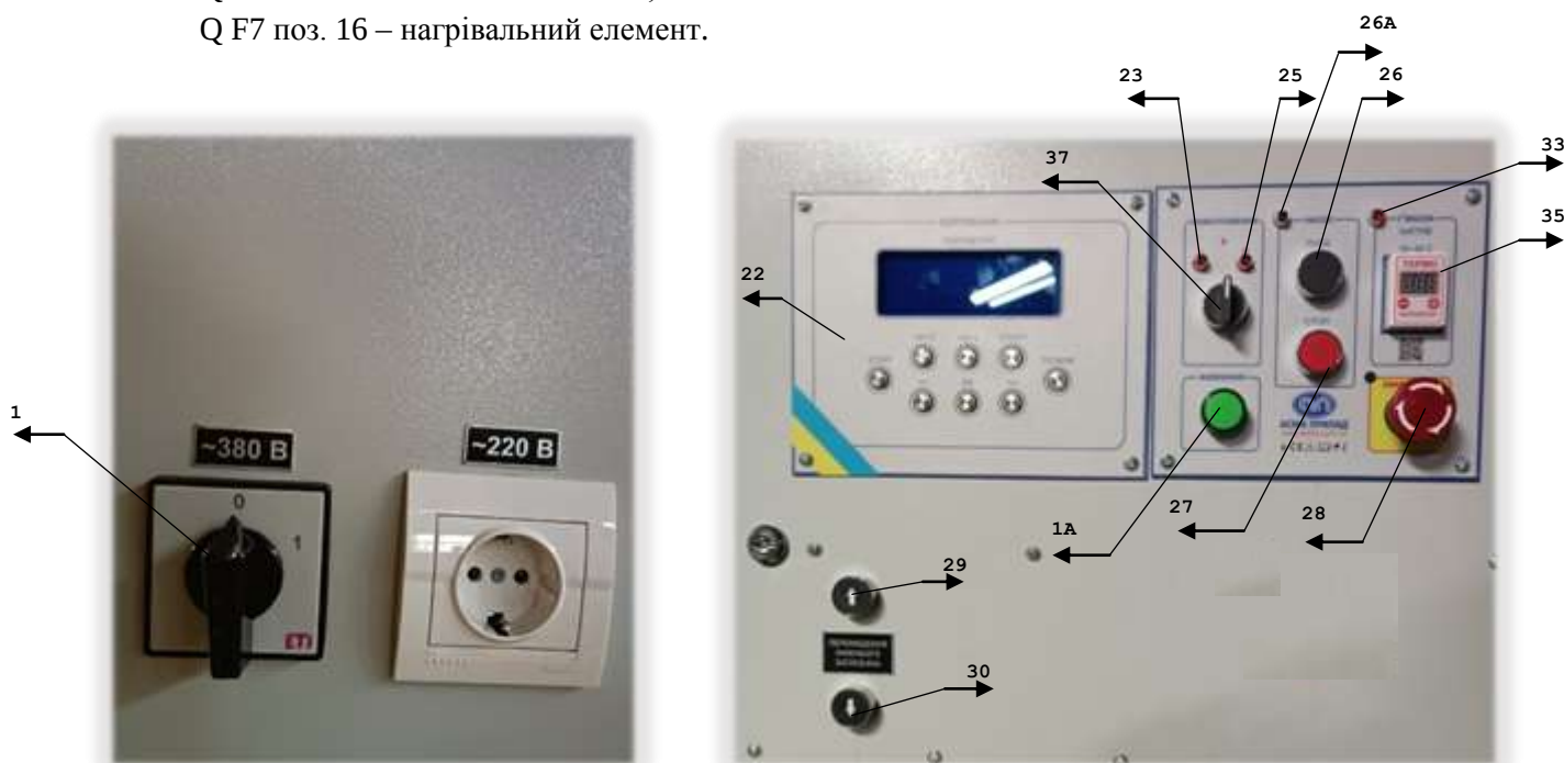
Мал .3 – Пульт керування масляною станцією
