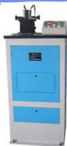
Стенд оснащен гидравлическим приводом с устройством двойной протяжки, что является преимуществом, так как позволяет проводить технологический процесс с двумя образцами за тоже время.
