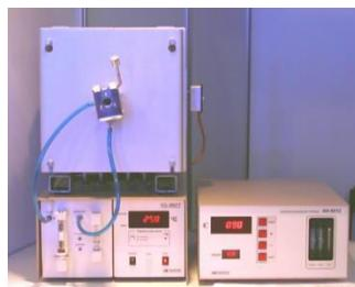
Экспресс-анализатор АН-8012 предназначен для определения содержания углерода в металлах.
