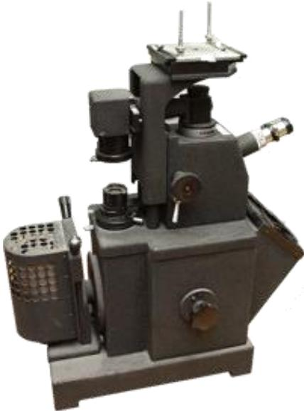
Микроскоп металлографічний вертикальний МИМ - 7 призначений для спостереження і фотографування мікроструктури металів в звичайному світлі в світлому і темному полі і в поляризованому світлі в світлому полі.
