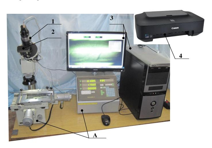
где A – Измерительный микроскоп ИМЦ 100×50 A
