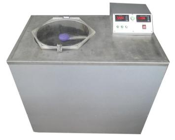
Камера КСТ-2 предназначена для испытаний образцов в условиях атмосферы нейтрального или кислого соляного тумана (ГОСТ 9054-75, ГОСТ 9308-85, ГОСТ 9401-89 и др.), с целью определения коррозионной стойкости.
