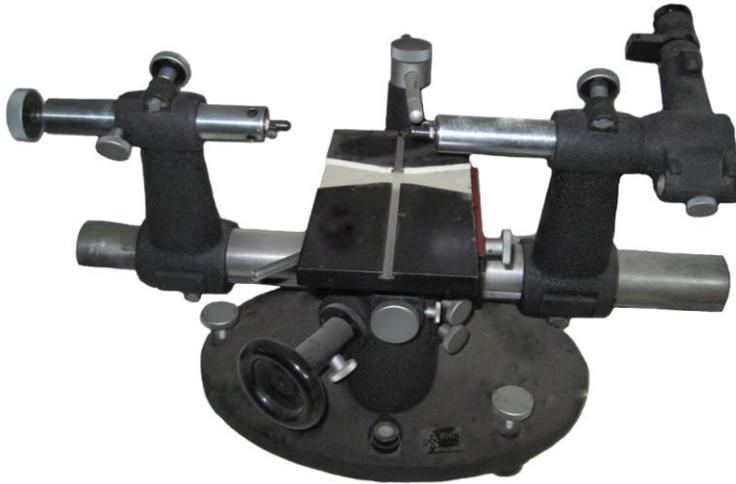
Оптиметр на горизонтальном штативе ИКГ предназначается для измерения наружных и внутренних линейных размеров методом сравнения измеряемого изделия с концевыми мерами, калибрами или деталями-образцами. В частности, на приборе могут производиться измерения концевых плоскопараллельных мер длины (измерительных плиток), калибров, диаметров шариков, внутренних диаметров калибров и изделий и т.д.
