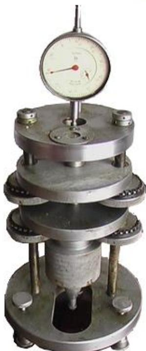
Прибор предназначен для определения твердости резины методом вдавливания стального шарика, находящегося под действием постоянной нагрузки, согласно ГОСТу 253—53.
