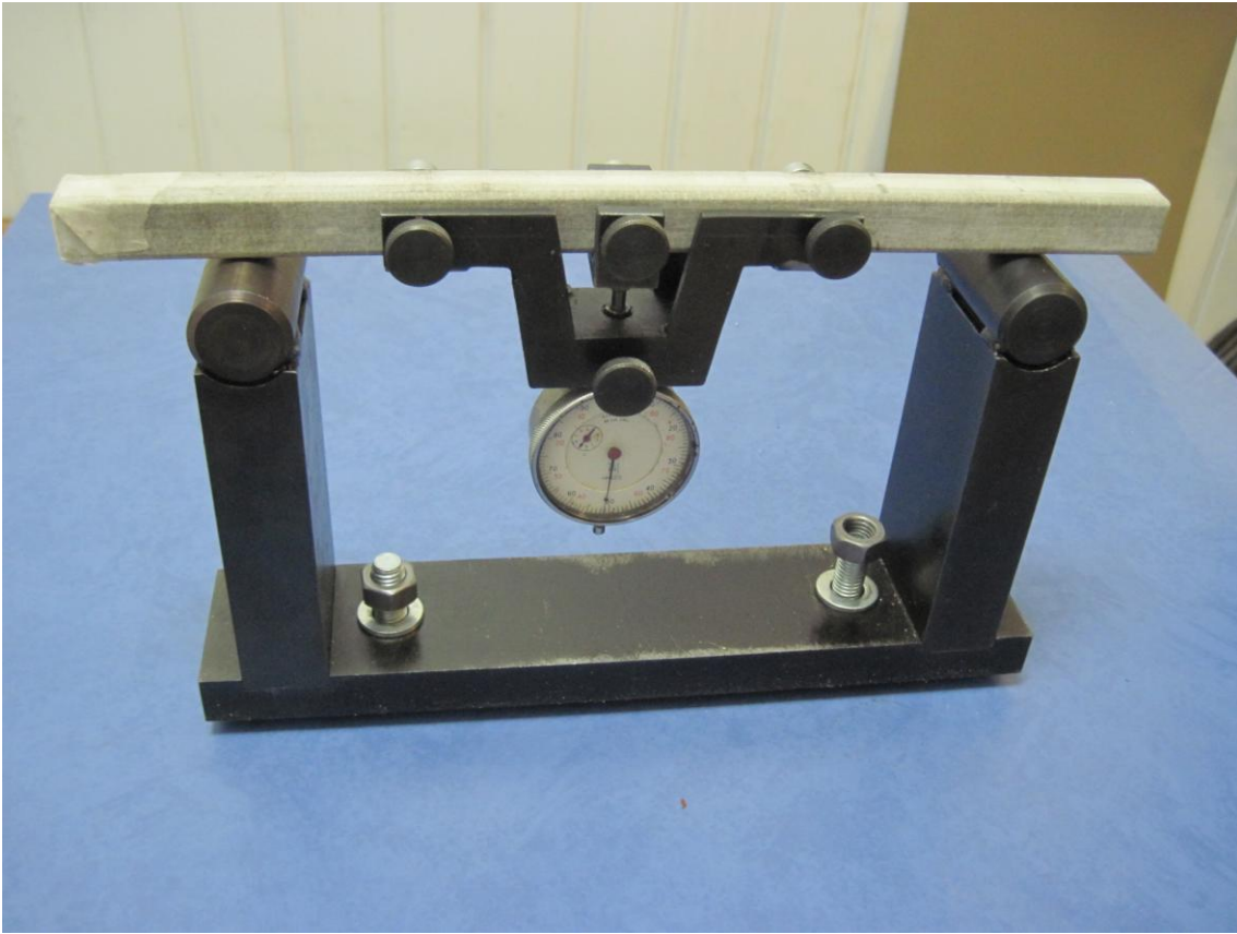
Рисунок А – Приспособление для испытания древесины на изгиб
